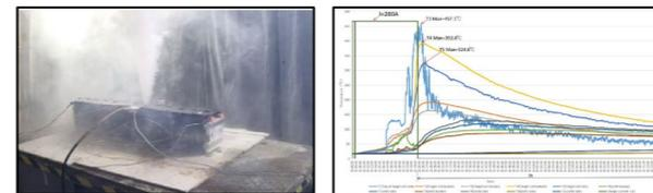
我司电池包防热失控设计，并能控制包内热失控可燃气体的流路，
