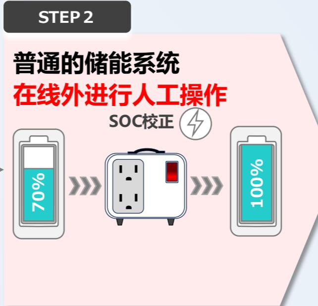
需要对替换电池Pack进行SOC的校正工作SOC一致了（即压差相同）才能接入系统
